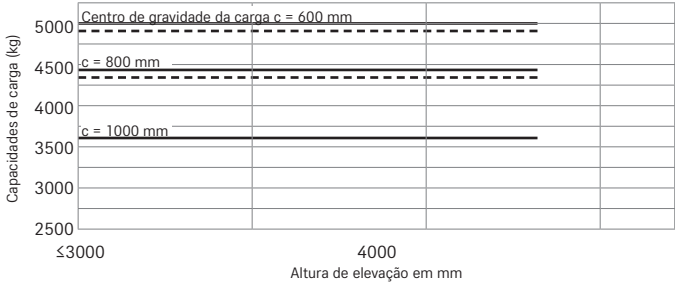
RX 60-50/600 Mastro Triplex/single pneus SE até 2350 mm de altura
