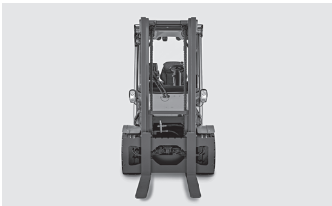
O mastro estreito assegura uma excelente visibilidade dos garfos e padrões de segurança extremamente elevados
